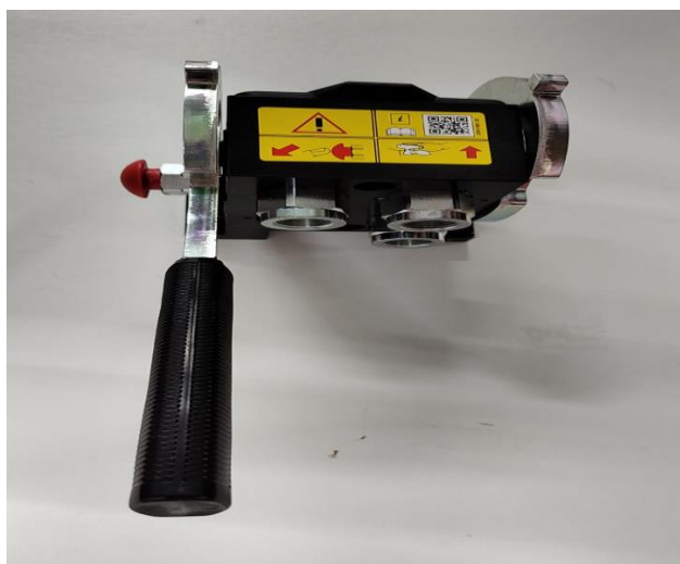
Foto aérea do engate rápido hidráulico da máquina.
